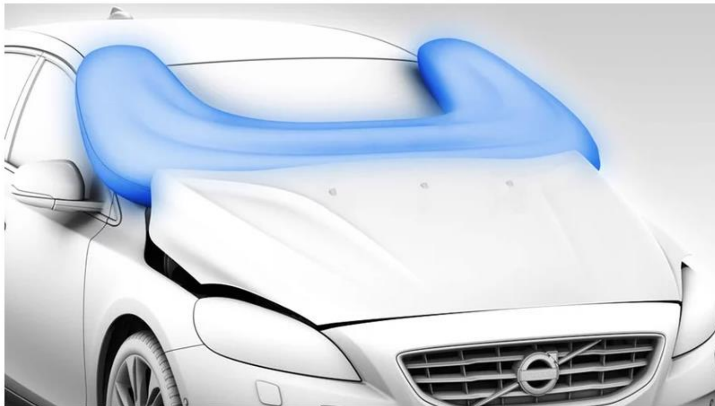
Volvo, très impliqué dans la sécurité, a imaginé un airbag extérieur pour sa V40 (crédits Volvo)
